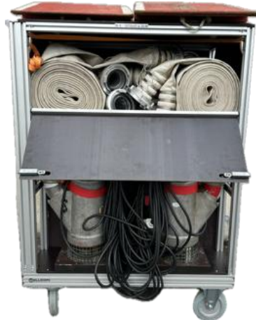
Rollcontainer Pumpen 4x Tauchpumpen Mast Schlauchbrücken 8x 20m Druckschläuche
