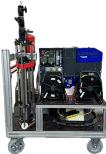
Rollcontainer Beleuchtung Notstromerzeuger 8kVA Stativ, Kabeltrommel LED Powermoon Feuerlöscher
